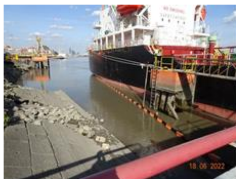
ภาพที่ 2-3 การล้อมท่อน (Boom) รอบลำเรือบรรทุก
